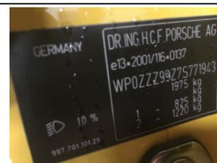
Numéro de série gravé sur le pare-brise frappé sur le châssis et étiquette constructeur portière droite
