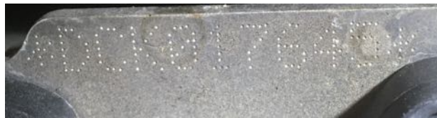
Frappe à froid numéro de moteur
