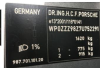
Numéro de série frappé sur le châssis, gravé sur le pare-brise et étiquette constructeur portière droite
