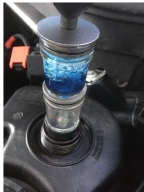
Absence de CO2 dans le liquide de refroidissement
