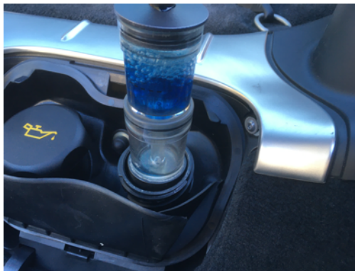
Test de CO2 dans le liquide de refroidissement
