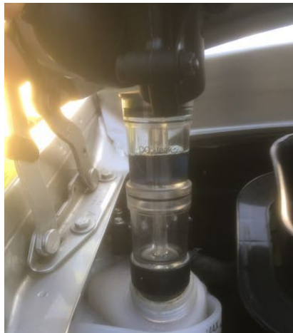
Absence de CO2 dans le liquide de refroidissement
