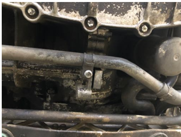
Absence de suintement jonction moteur/boite
